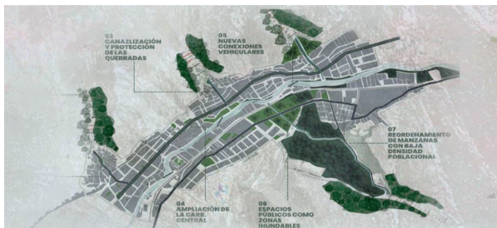
Figura 7. Obras de Mitigación en quebrada Libertad: andenes, reasentamiento de viviendas, despeje para canal de desfogue, presas de retención y mallas geodinámicas.
