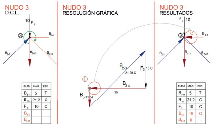
Figura 23. Resolución gráfica del Nudo 3, finalización. [Gráfico realizado por el autor. Lima, 2018].
