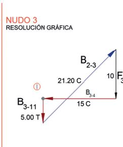
Figura 21. Resolución gráfica del Nudo 3, proceso. [Gráfico realizado por el autor. Lima, 2018].
