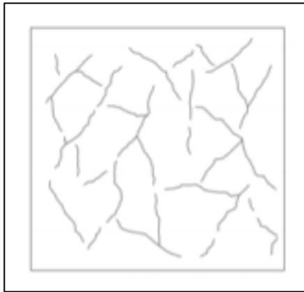
**Figura 5.** Representación típica de fisuración por retracción plástica
