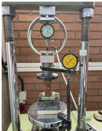
Foto 01 y 02: Copa de Casagrande para determinar el límite líquido y equipo de compresión simple del LMSA de la URP
