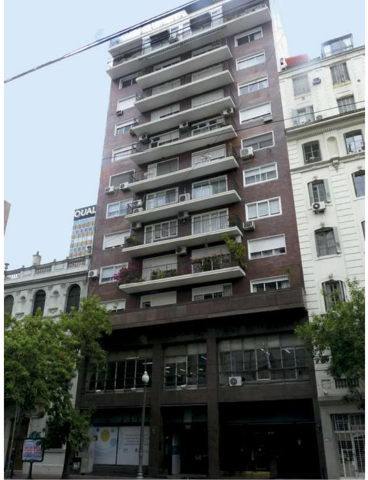
Figura 10. Edificaciones con losas en voladizo, ladrillo cara vista y muros revestidos. Avenida Córdoba, Buenos Aires.
