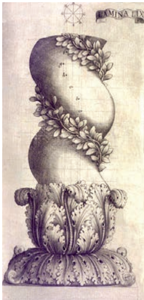
Fig.2. Diseño de una columna salomónica del tratado de Juan Caramuel. Caramuel, J. (1679). Architectura civil, recta y obliqua, considerada y dibuxada en el Templo de Ierusalem , tomo III, sección III, lámina LIX.
