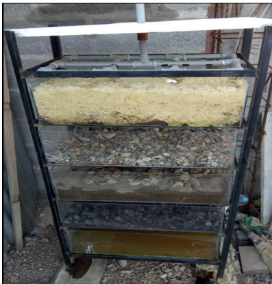
Figura 1. Recubierto de vidrio / lombrifiltro.
