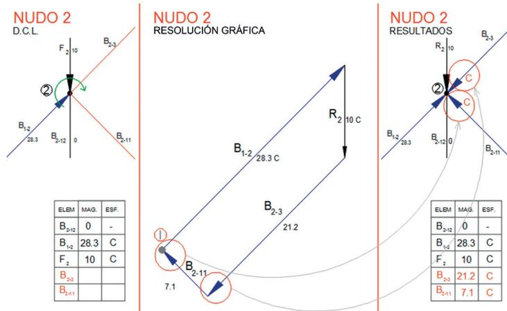
Figura 15. Resolución gráfica del Nudo 2, finalización. [Gráfico realizado por el autor. Lima, 2018].
