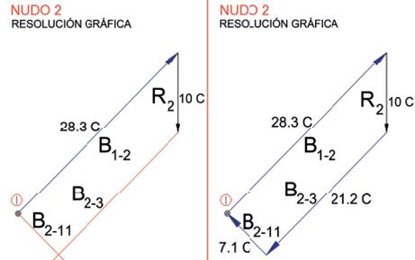
Figura 14. Resolución gráfica del Nudo 2, proceso. [Gráfico realizado por el autor. Lima, 2018].
