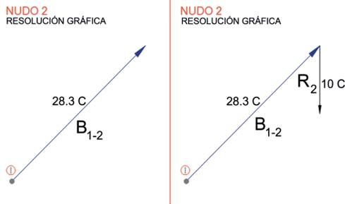
Figura 13. Resolución gráfica del Nudo 2, proceso. [Gráfico realizado por el autor. Lima, 2018].
