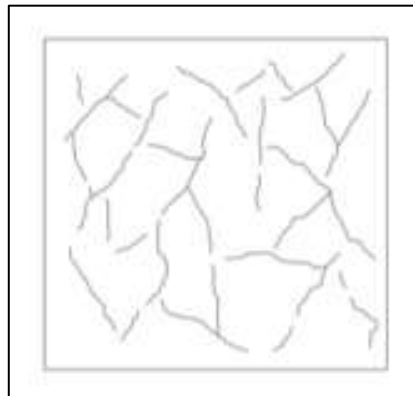
Figura 7. Representación típica de fisuración por retracción plástica [5]
