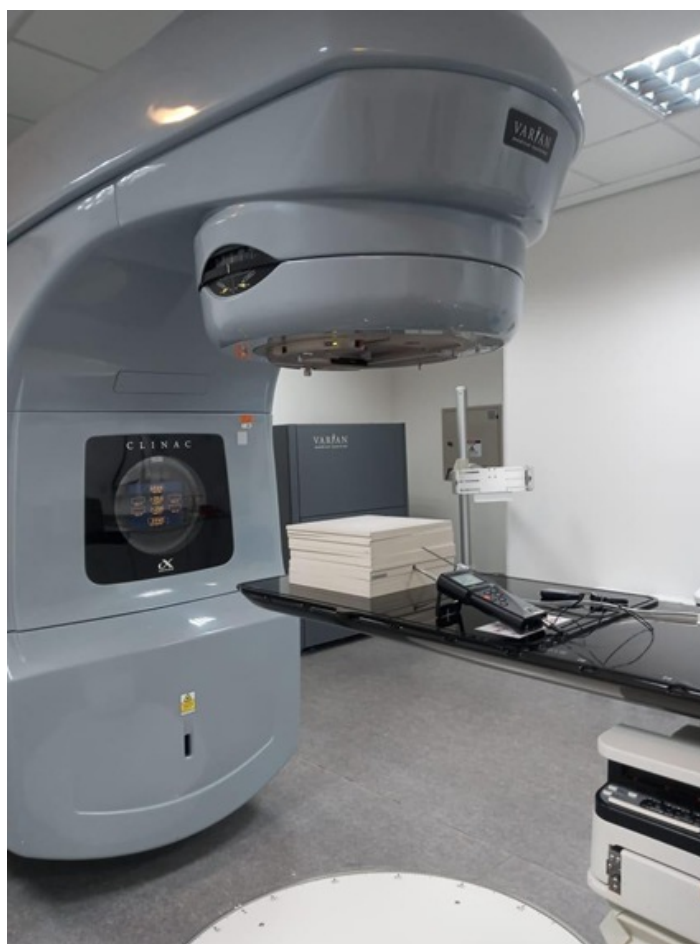
Figura 1. Posicionamiento de la cámara de ionización en el objeto simulador de agua sólida.
