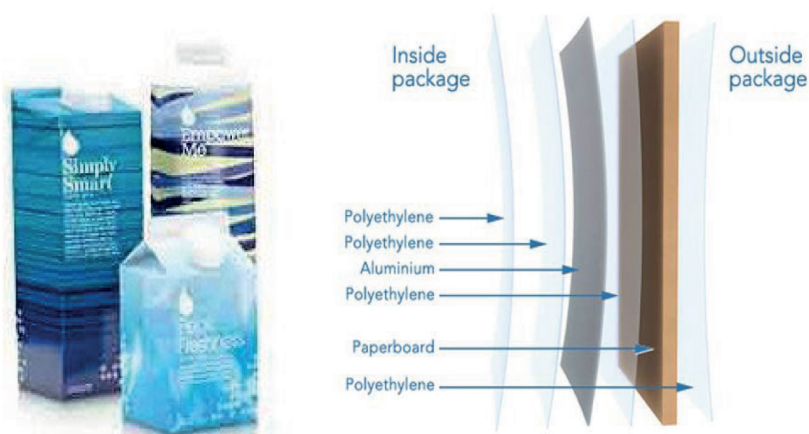
FIGURA 8. Capas que conforman un envase de Tetra Brik. Fuente: Portal web de Tetra Pak
